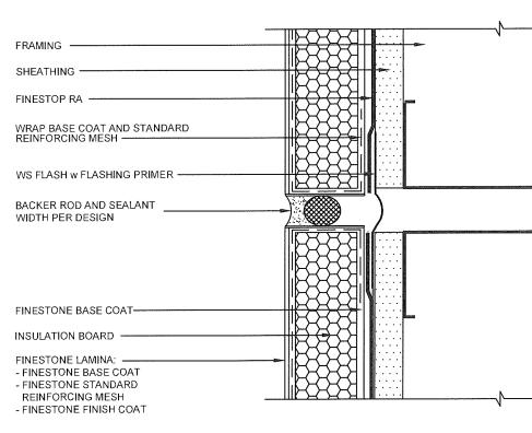
EXPANSION JOINT DETAIL (PLAN VIEW)
